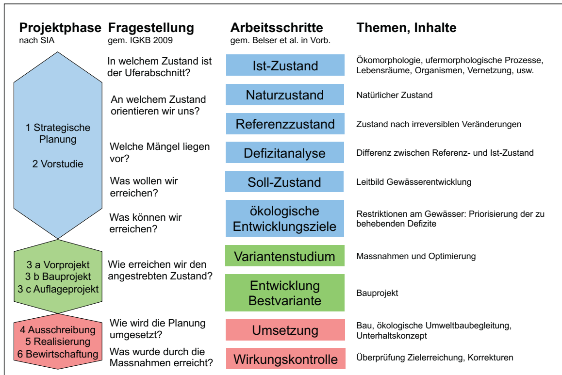
Abb. 5: Übersicht über das systematische Vorgehen bei einer Seeuferrenaturierung [aus Belser et al. in Anhörung 2020, IGKB 2009, abgeändert] | Fig. 5 : Aperçu de l'approche systématique de la renaturation des rives lacustres [extrait de Belser et al., en procédure d'audition 2020, IGKB 2009, modifié]
