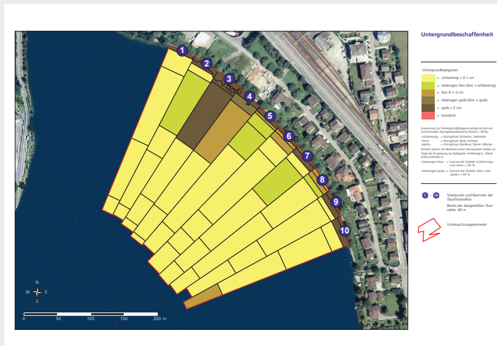
Fig. 8 Flächendeckende Wasserpflanzenenerhebung im Alpnachersee (Hotspot «Garnhänki»). Darstellung der Untergrundbeschaffenheit in Form der vorherrschenden Korngrösse auf der Basis der quantitativen Verteilung der sechs Korngrössenklassen Analyse étendue des plantes aquatiques dans l'Alpnachersee (zone sensible: «Garnhänki»). Représentation de la géologie du sous-sol sous forme de granulométrie prédominante, sur la base de la répartition quantitative des 6 classes granulométriques
