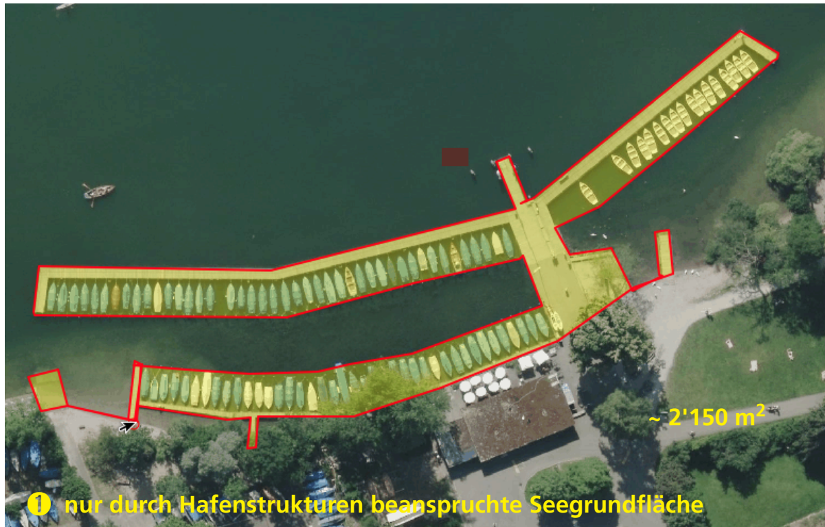
Abb. 4: Darstellung und Vermessung der relevanten Hafenfläche «Hafen MUSTER» als Grundlage für die Bemessung des Ersatzbedarfes.
