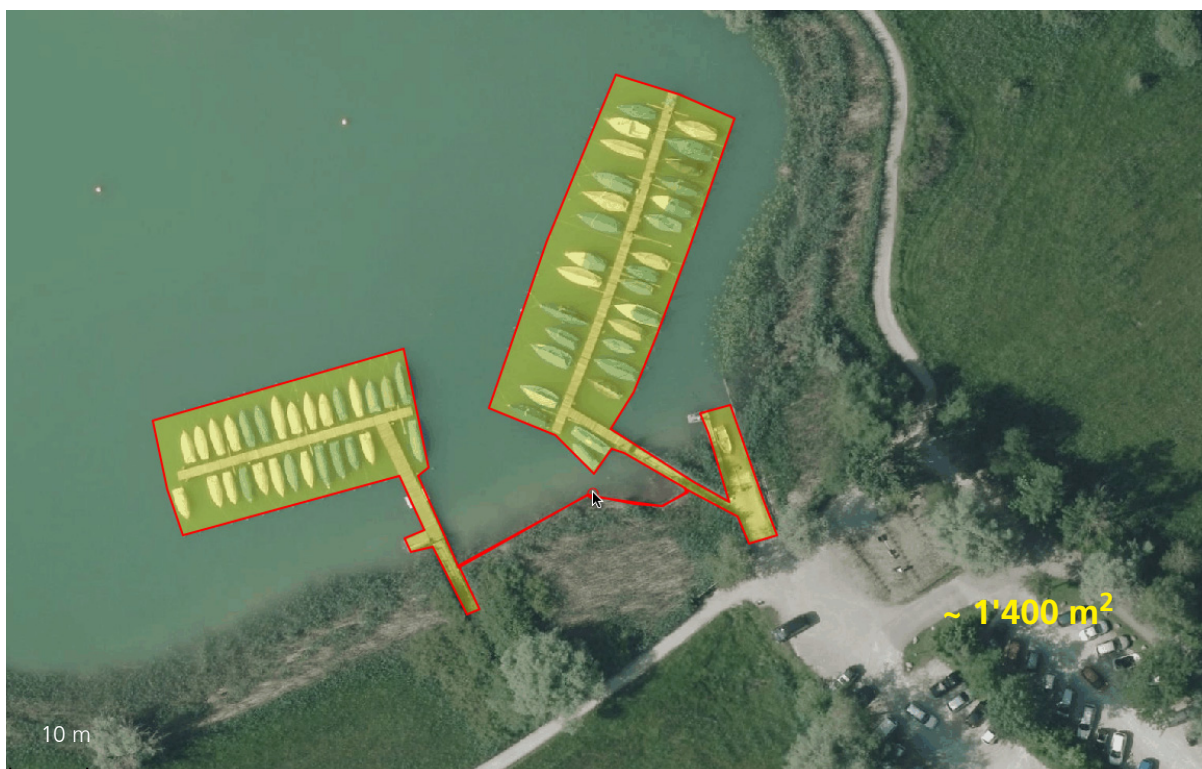
Abb. 3: Darstellung und Vermessung der massgeblichen Flächengrösse an zwei Beispielen von Hafenanlagen als Grundlage für die Bemessung des Ersatzbedarfes.
