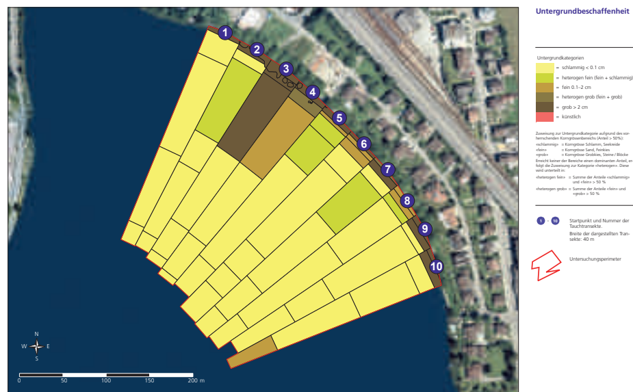
Fig. 8 Flächendeckende Wasserpflanzenerhebung im Alpnachersee (Hotspot «Garnhäkni»). Darstellung der Untergrundbeschaffenheit in Form der vorherrschenden Korngrösse auf der Basis der quantitativen Verteilung der sechs Korngrössenklassen
